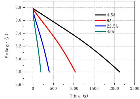
UCK42V9000 在 2.8~4.05V (左) 和 2.8~3.8V (右) 电压区间的放电曲线
